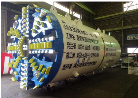
平成 27 年 9 月 シールドマシン (幹線工事 1)
