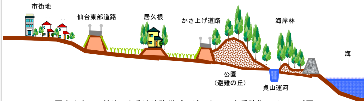
図 2-1-2 みどりによる津波防災プロジェクトの多重防御のイメージ図
