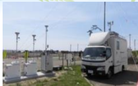
【移動測定車による大気調査】
