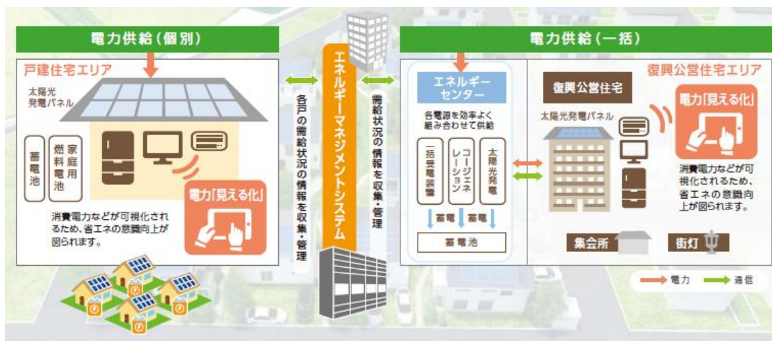
図 1-1 田子西地区におけるエネルギーマネジメントの概念図
