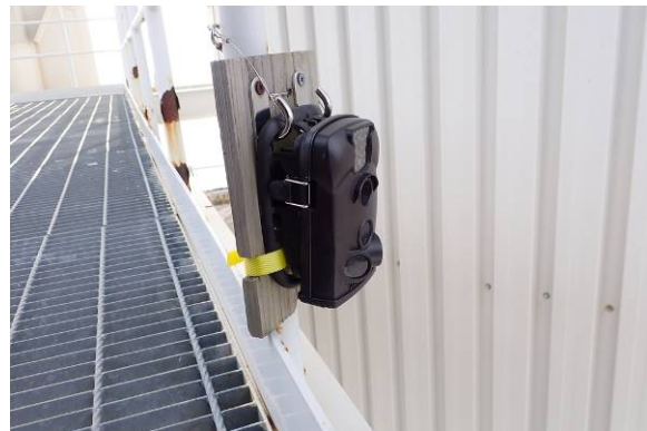
固定カメラ設置状況（令和4年1月31日撮影）
