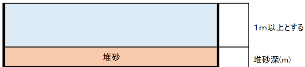
図 2.2-15 流末仮設沈砂池の平面及び断面の略図
