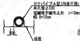
浸出水集排水管 (法面部)
