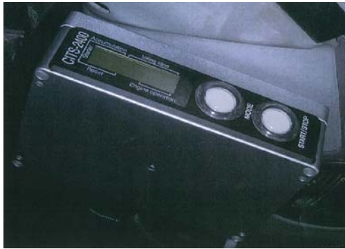
図 6-4 建設機械のアイドリングストップ装置 (平成 24 年 11 月 1 日)
