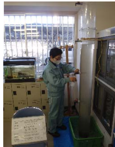
図 6-16 沈降試験実施状況 (平成 23 年 3 月 5 日撮影)
