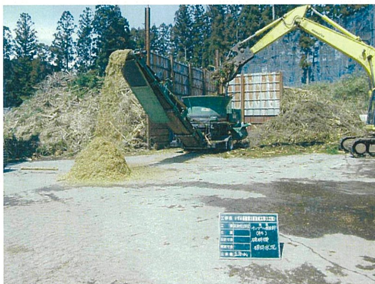
写真 8-9-5 伐採木枝条の委託先での破碎処理状況(平成 24 年 4 月 5 日撮影)
