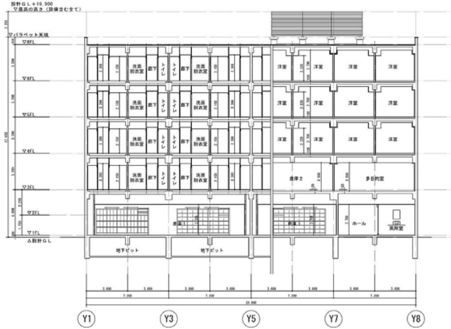
図 4.1-9-1(1) 研修医宿舎棟断面図 (南側住戸) (完成時)
