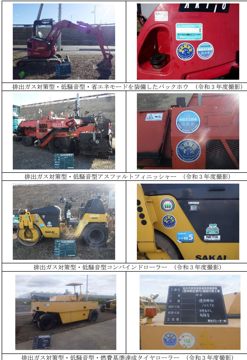
写真 6.2-1 排出ガス対策型・低騒音型・燃費基準達成建設機械の使用例
