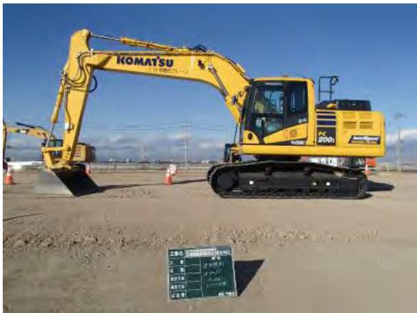
排出ガス対策型・省エネモードを装備したバックホウ（平成29年度撮影）
