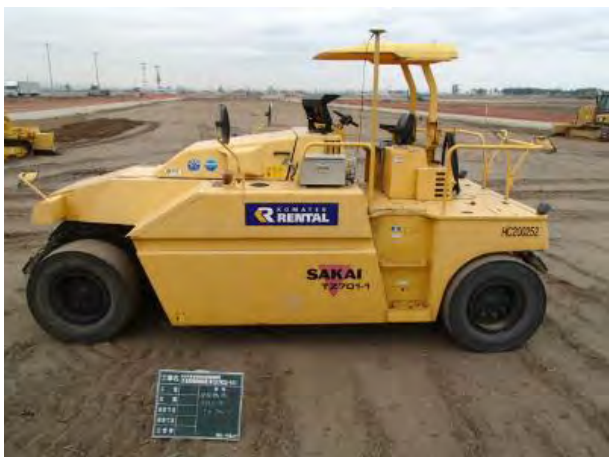
排出ガス対策型タイヤローラ（平成29年度撮影）
