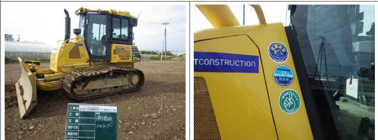
排出ガス対策型・低騒音型・燃費基準達成ブルドーザ（平成 30 年度撮影）
