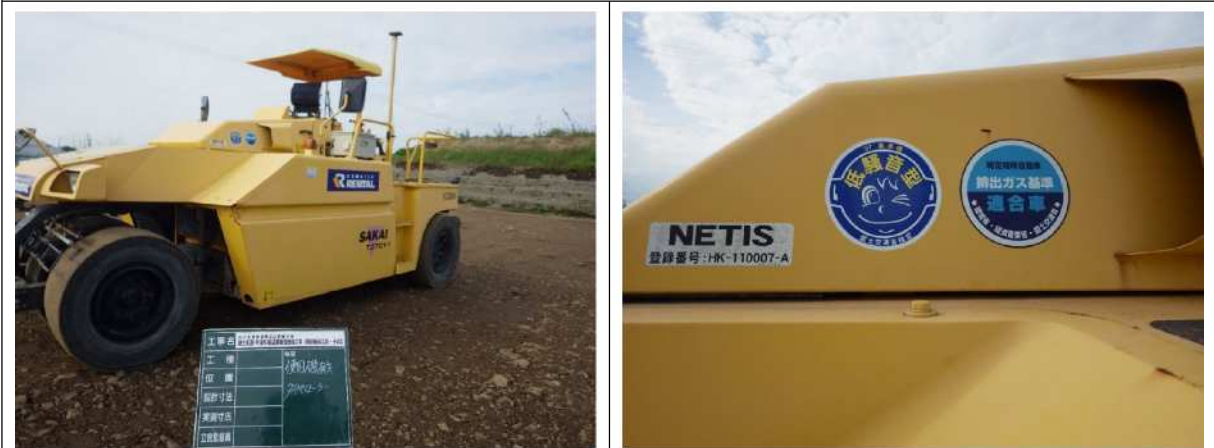
排出ガス対策型・低騒音型タイヤローラ（平成 30 年度撮影）
