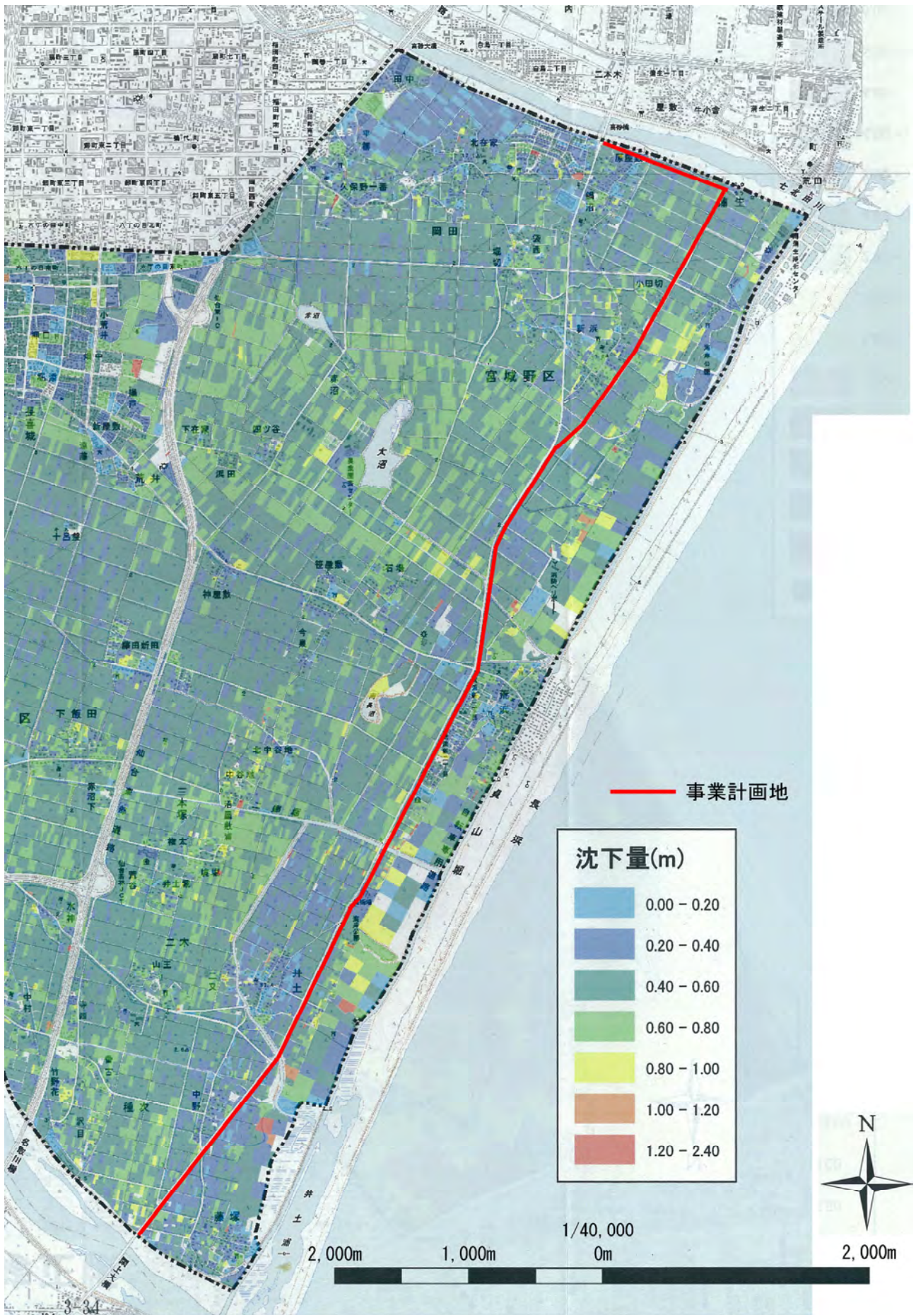
図 6.1.3-6 東日本大震災による地盤沈下量区分図
