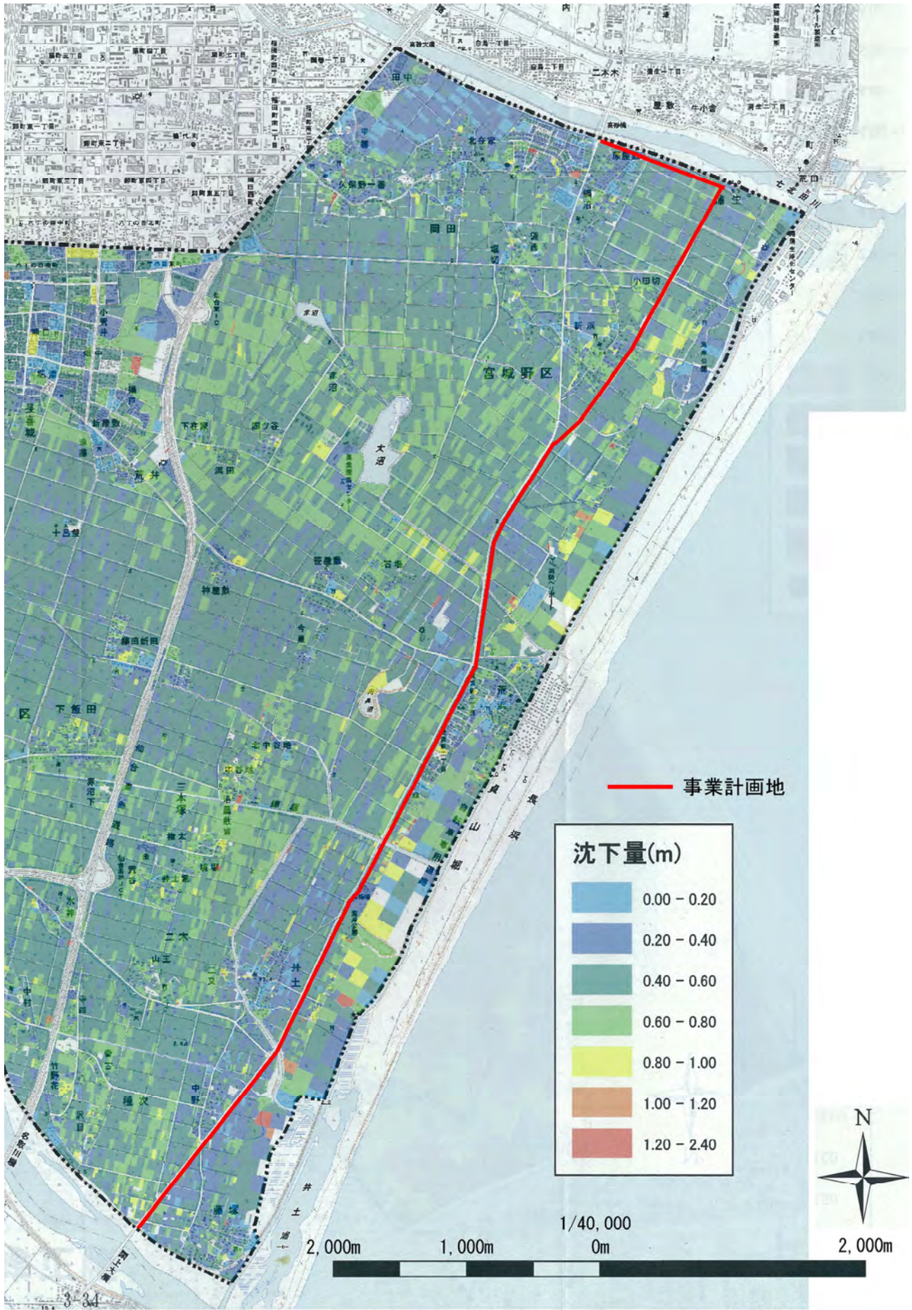
図 8.6-5 東日本大震災による地盤沈下量区分図
