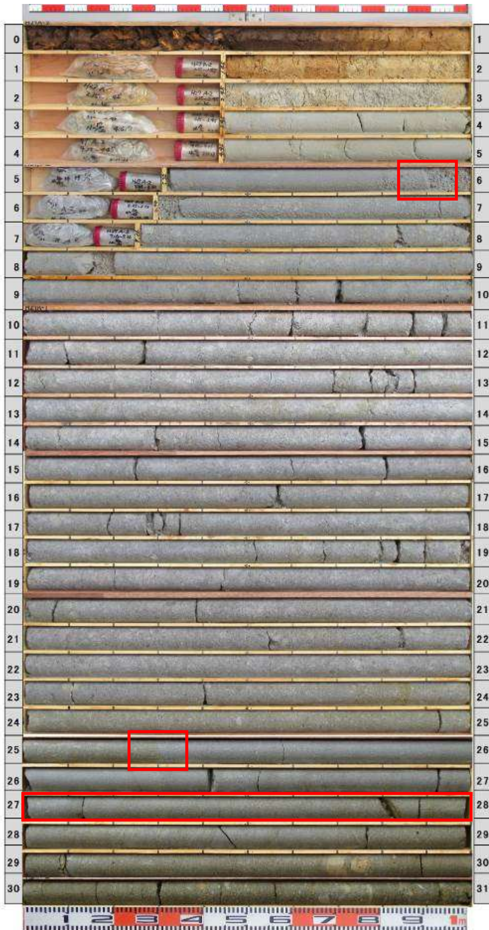
図 8.6-21 ボーリングコア写真と地層境界の状況 (切土断面①: H27A-2)
