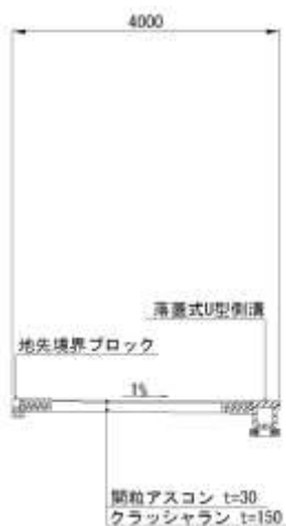
図 1.4-7(6) 道路標準断面図（自転車歩行者道）
