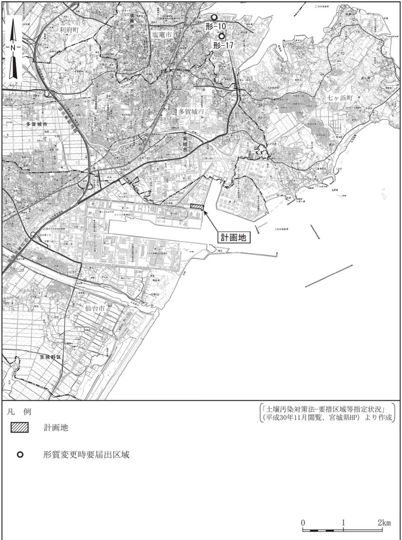
図 6.1.3-10 土壌汚染対策法に基づく要措置区域等の指定状況
