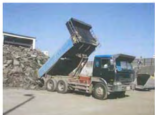
(アスファルトの積み下ろし)
