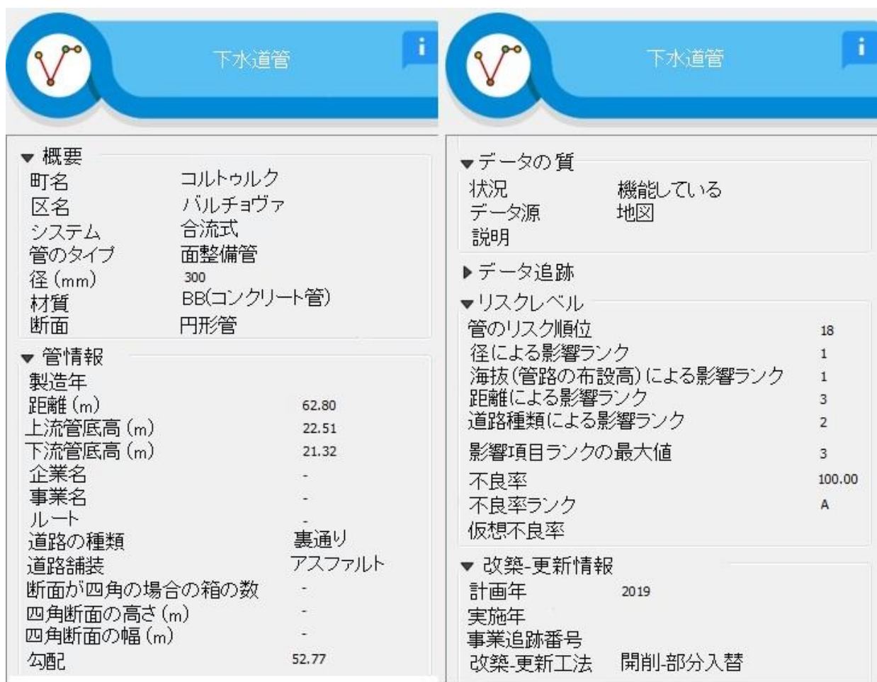
図 2. GIS における下水道管データの構成
