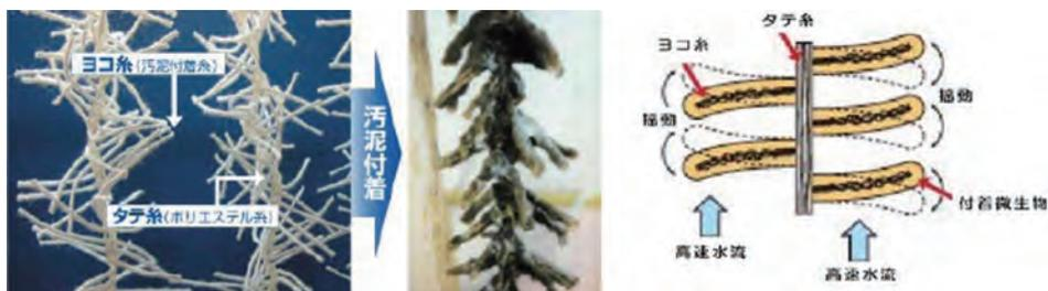
図b ろ材への汚泥付着状況
