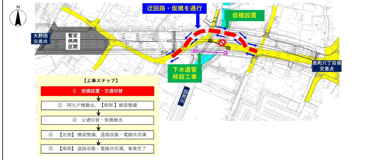
(2) 施工ステップ②：旧橋撤去・【南側】橋梁整備・・・現在
