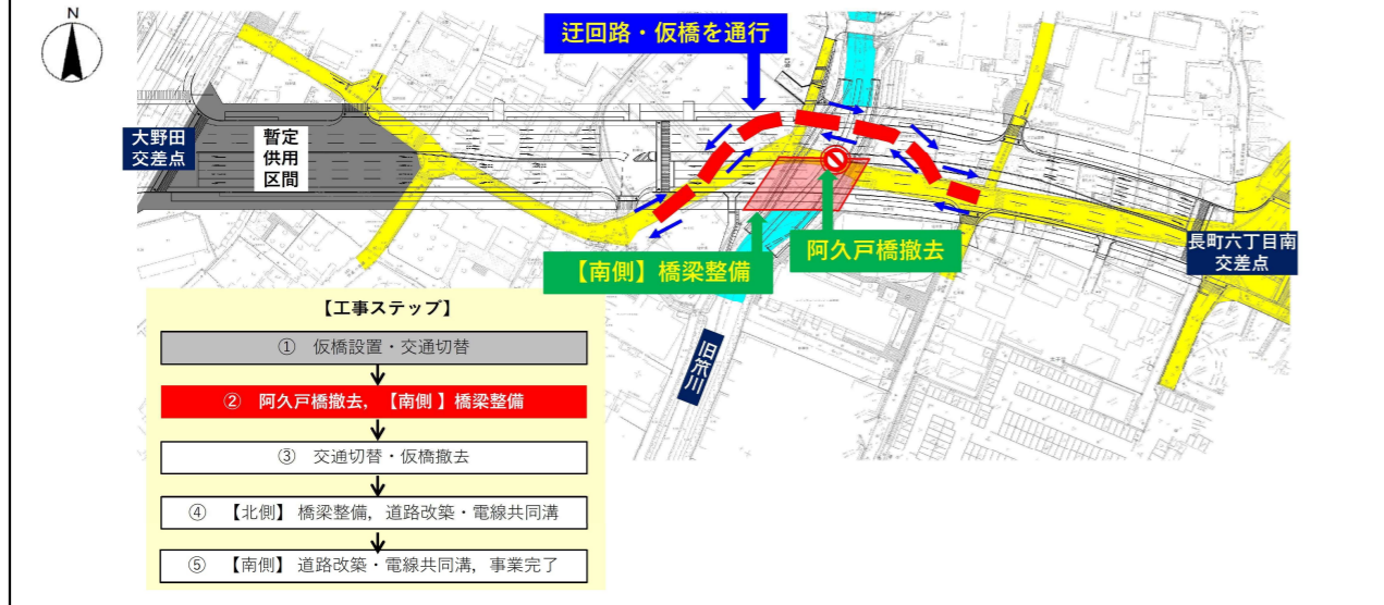
(3) 施工ステップ③：交通切替・仮橋撤去
