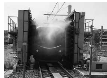
▲車両の自動洗浄機。洗浄の仕上げに逆浸透膜水(RO水)を使い窓ガラスの白濁防止をしています。イベントで子どもたちを乗せて通過するのが人気です
