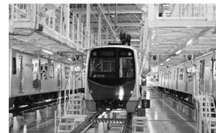
▲車両の自動洗浄機。洗浄の仕上げに逆浸透膜水(RO水)を使い窓ガラスの白濁防止をしています。イベントで子どもたちを乗せて通過するのが人気です
