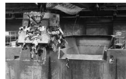
▲クレーンで約2.2トンのごみを持ち上げ、焼却炉投入口へ入れます。ごみの乾燥状態などに応じて投入量を調整します
