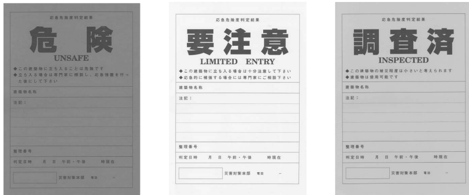
図表 4-6-3 被災建築物応急危険度判定のステッカー
