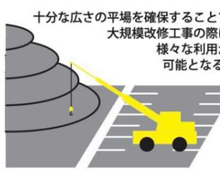
どこからでもアプローチできる建築であることから、大規模改修時には出入口を限定することで工事範囲を明確に分割し施設を閉鎖しないで工事を行うことができます。諸室はホワイエなどの動線の広場を介して配置しているため、施設利用者動線と工事業者動線を明確に区分でき、運営管理しやすい計画とします。
