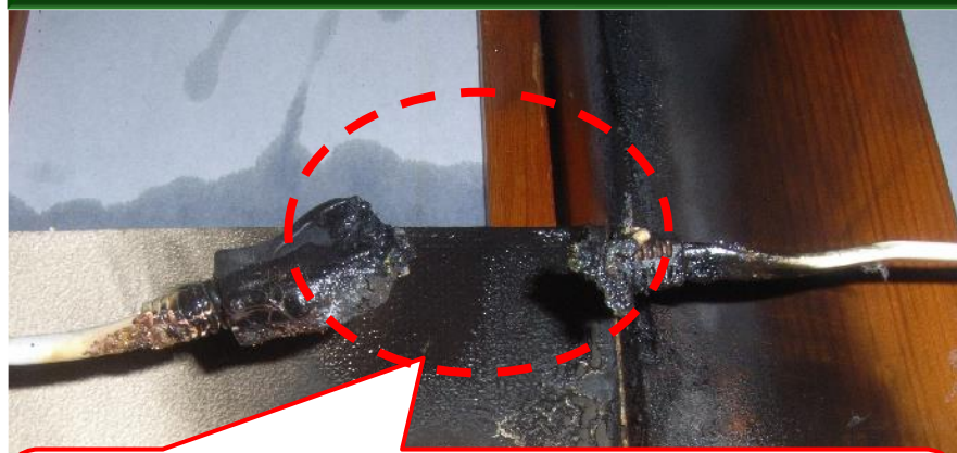
トラッキング現象により焼損したコンセント
