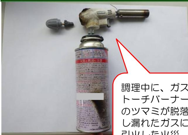
調理中に、ガストーチバーナーのつまみが脱落し漏れたガスに引火した火災
