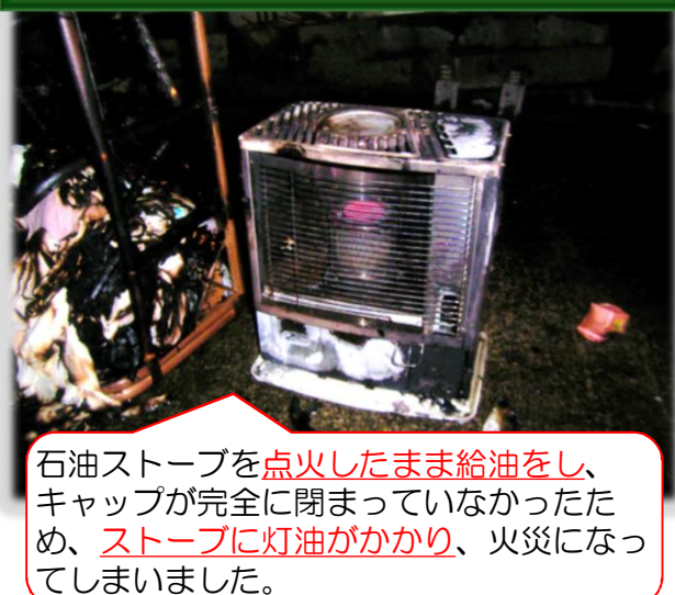
石油ストーブにより出火した事例
