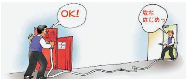
出火箇所に接近した操作員の「放水はじめっ！」の合図で、消火栓のバルブを開放し放水します。
