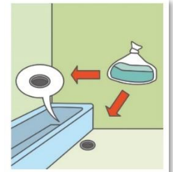
水のうでトイレや お風呂場の排水口 をふさぐ
