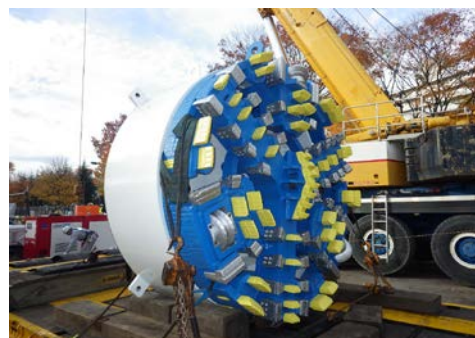
平成 28 年 11 月 シールドマシンカッタ部 (幹線工事 2)
