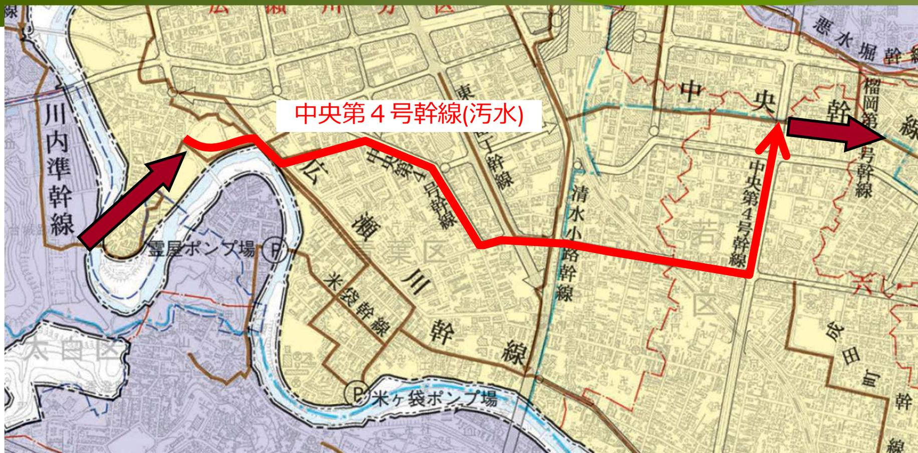
【対策】 広瀬川の水質改善、雨天時汚濁負荷の低減となります。大雨時の広瀬川への放流量等を減らすべく、汚水幹線である中央第4号幹線を整備し、分流汚水を中央幹線に導き処理場へ流下させます。
