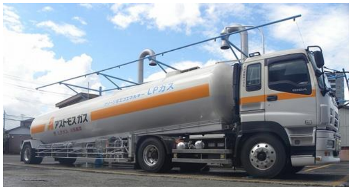
①ガスローリ車から受け入れ
