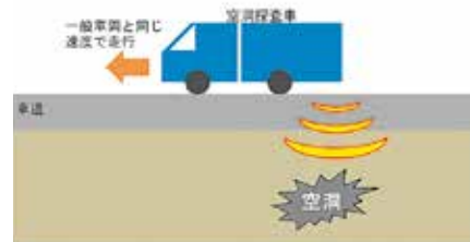
【路面下空洞調査の例】
