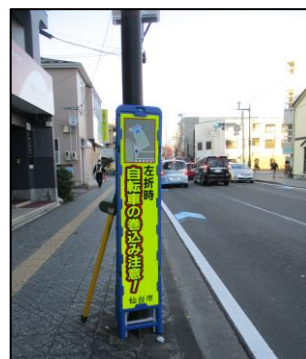
【写真 3-9】ラバーポール・看板等を用いた左折巻き込み事故対策の事例 (市道宮町通線)
