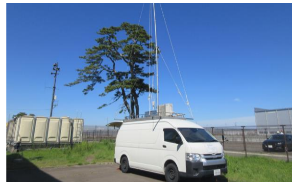
▲移動測定車による大気調査
