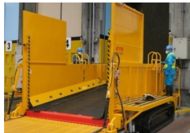
搬入物検査装置
