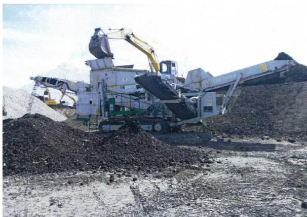
写真 9-1-23 移動式振動篩い機
