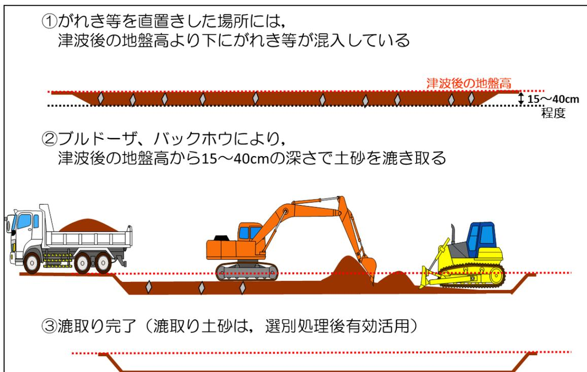
図 9-3-1 がれき等混じり土砂の漉き取り方法
