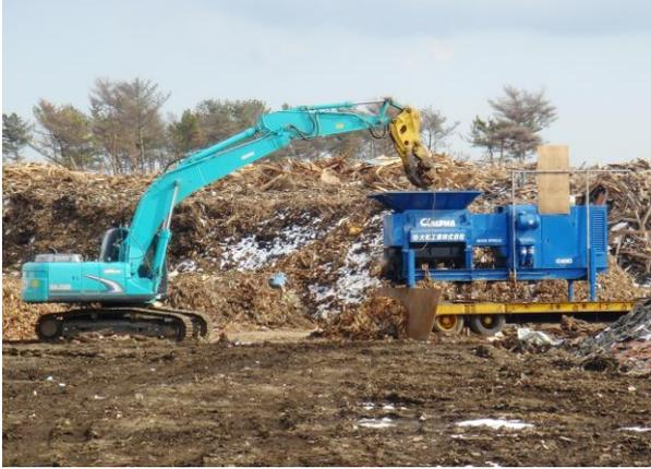
写真 9-1-4 可燃物の破碎状況
