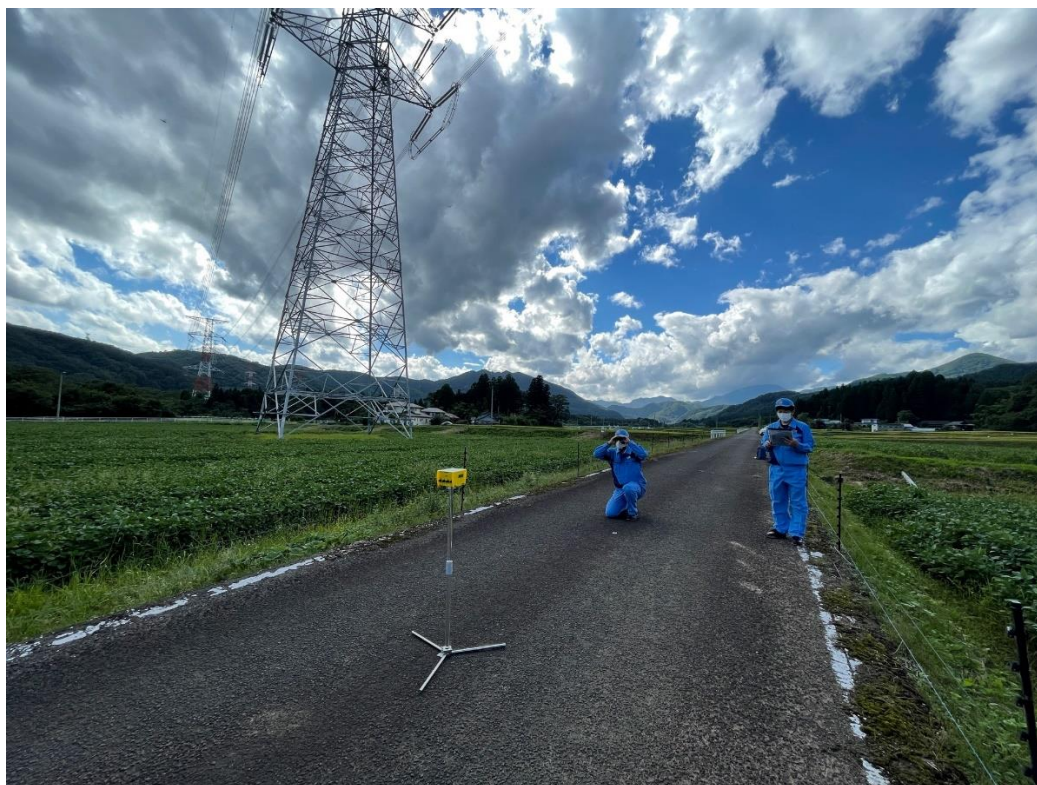
図 8.7-2 電界測定状況
