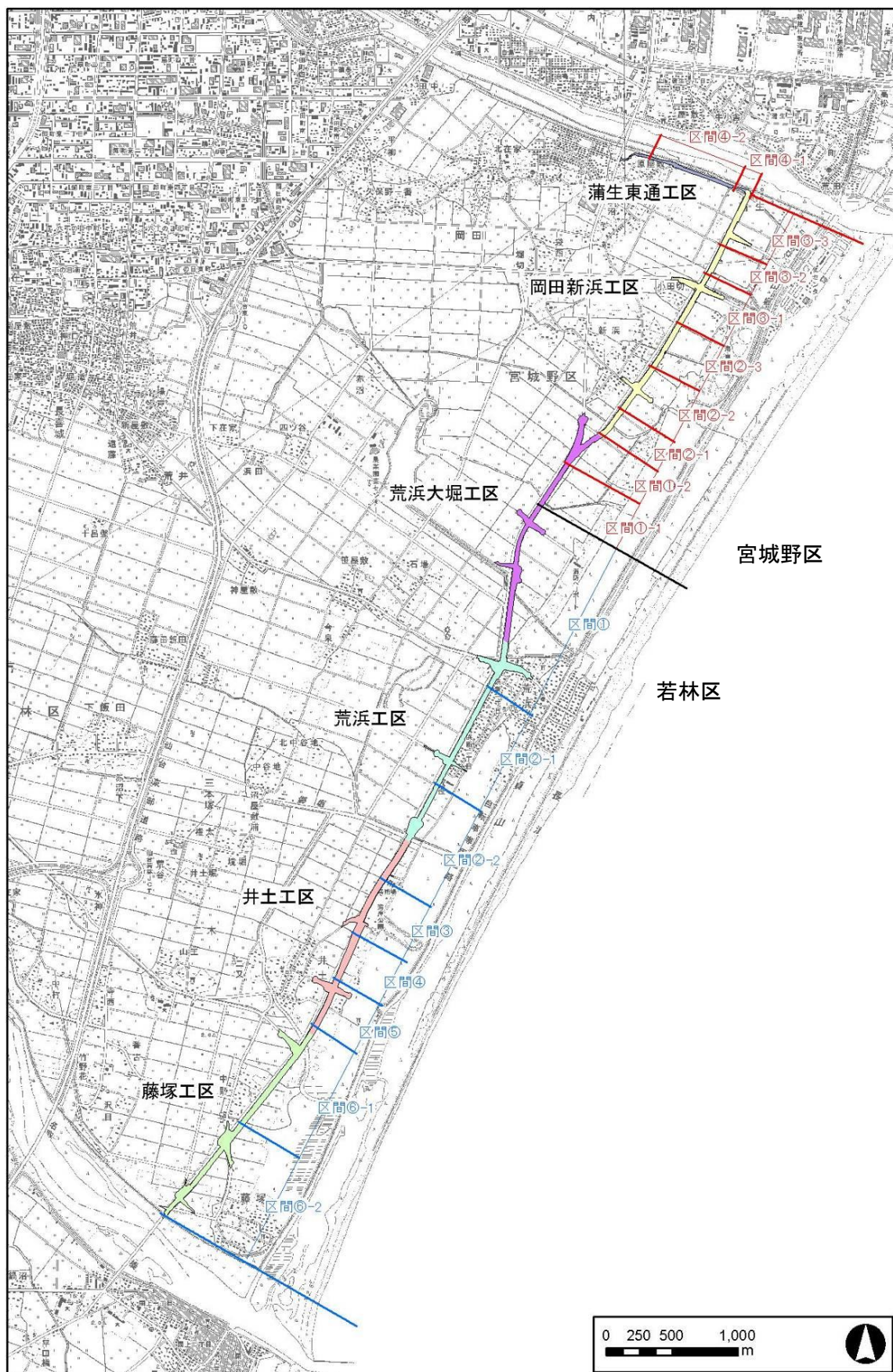
図 2.5-5 軟弱地盤対策工の区間区分
