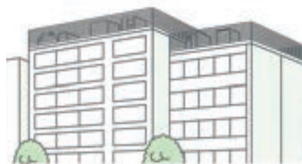
ルーバによる修景や壁面の分節化による圧迫感の軽減
