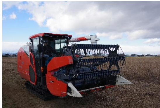
直委アシスト機能付き汎用コンバイン (食味・収量センサ付)
