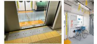
図 102 地下鉄のバリアフリー状況 (左:南北線ホーム、右:新型車両内)
