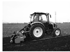
▲自動操舵トラクター耕耘 耕耘深さや作業機確認に注力が可能
