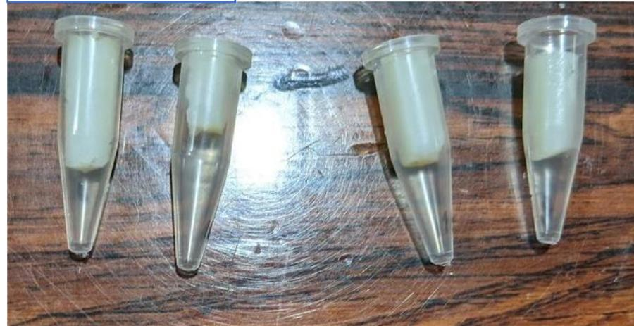
室温測定のサンプルは、600  $\mu$ L容プラスチックチューブに入れて準備することで、測定中の乾燥による変形を防ぎ、サンプル交換の手間を大幅に減らすことに成功した。
