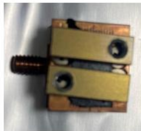
測定エンドステーション“BL9U”にてサンプルを試料台にセットしたもの
