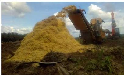
伐採した幹を専用の機械でチップング
