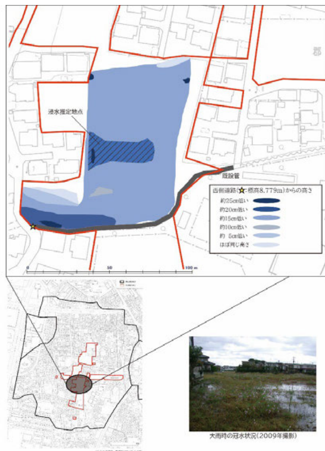
大雨時の浸水推定地点
