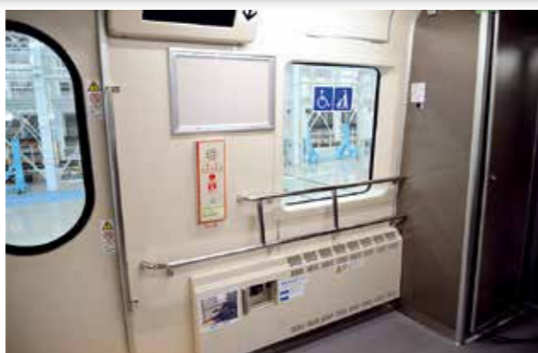
▲車いすやベビーカーの設置スペースを全車両に完備。車いすの固定ベルトや、障害者団体の意見等を取り入れて設置した縦手すりにより、安心・安全にお乗りいただけます
